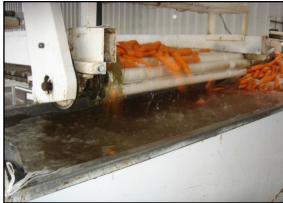
Figura 10. Empresa A: desinfección de zanahoria por medio de inmersión en solución germicida a base de ácido tricloroisocianúrico.
