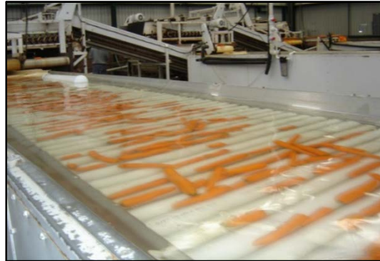
Figura 12. Empresa A: Enfriamiento de zanahoria por medio de inmersión en agua de 2 a 4 °C en “hidroenfriador”.
