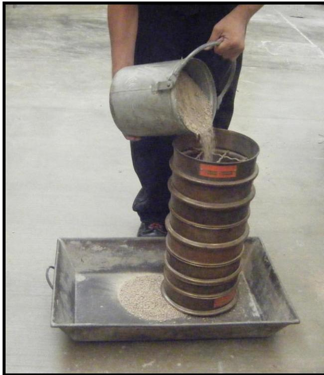
Figura 3.4 Cribado del material a través de las mallas.
