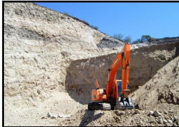
Figura 2.3 Explotación lateral en un banco de *tepetate*.
