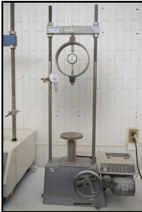
Figura 3.9 Equipo para la realización de pruebas de compresión simple y compresión triaxial.
