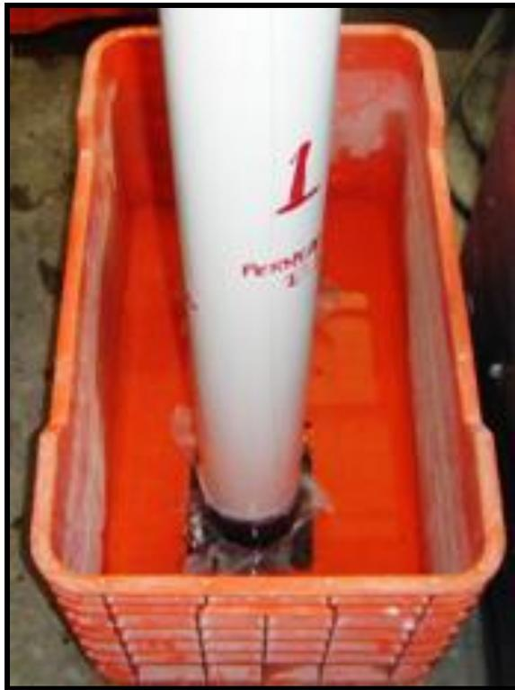
Figura 3.13 Permeámetro de carga variable adaptado al molde Proctor estándar.
