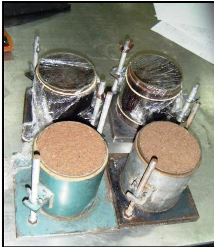
Figura 3.12 Preparación de especímenes de prueba para permeámetro de carga variable.
