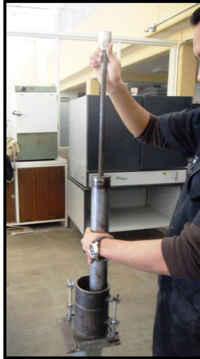
Figura 3.8 Elaboración del espécimen de prueba.
