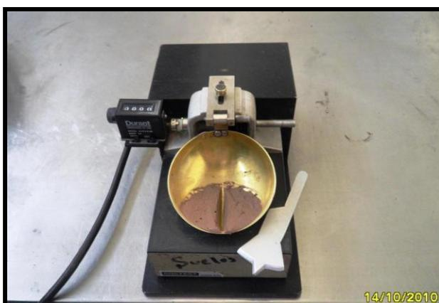
Figura 3.6 Forma como queda colocado el material en la copa de Casagrande.
