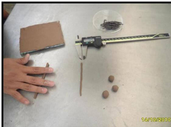
Figura 3.7 Determinación del límite plástico
