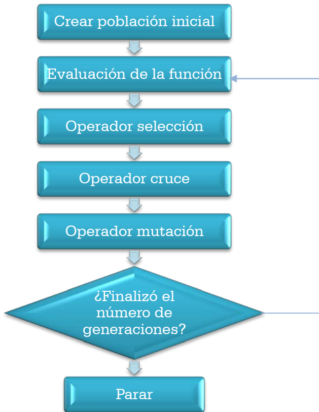
Fig. 14 Diagrama general del proceso de un AGE
