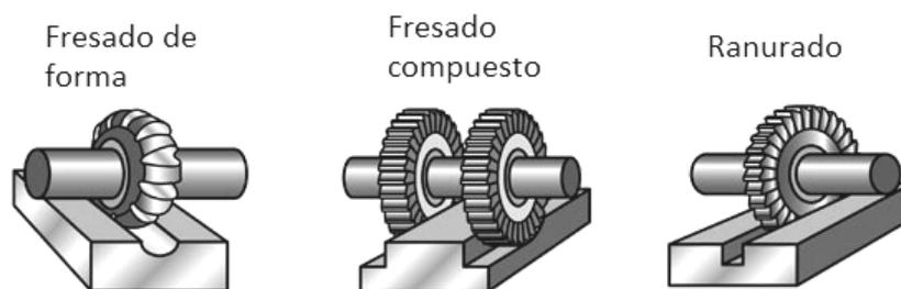
**Figura 2.31 Operaciones de fresado especializadas.**
