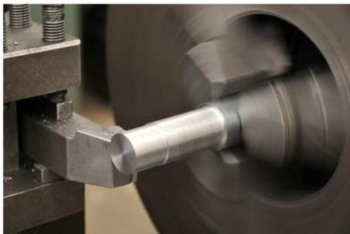
**Figura 2.22** Torneado de una pieza.
