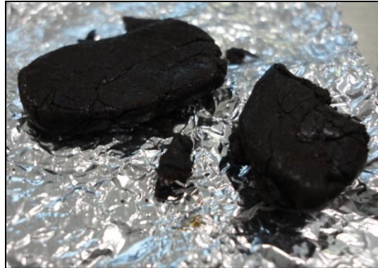
Fig. 7. Extracto de timbe sobre papel aluminio luego de la separación por rotavapor.
