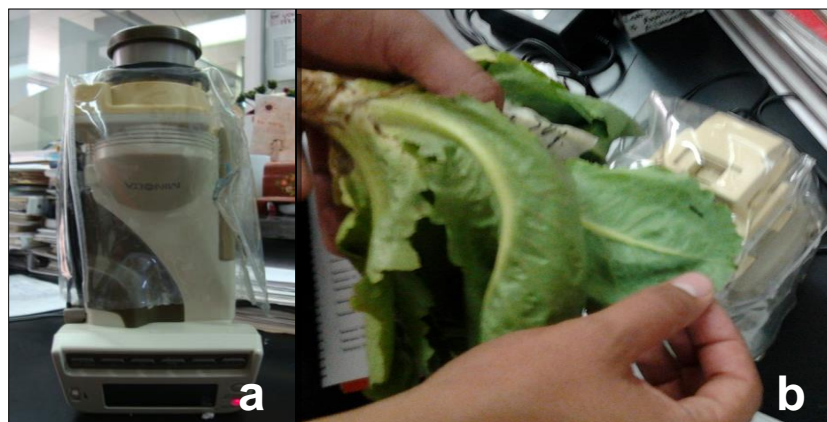
Figura 6. Medición de color en lechugas. a) Colorímetro Minolta y b) medición de los parámetros de color L^* , a^* y b^* en hojas de lechuga.
