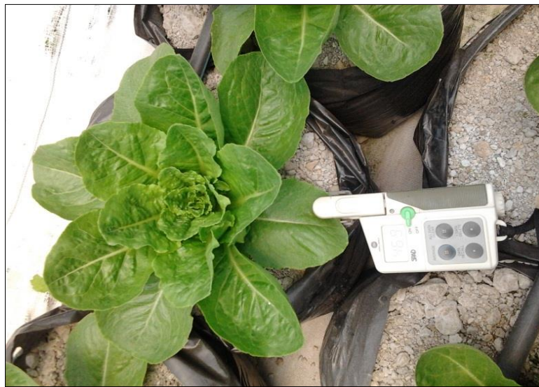
Figura 5. Medición no destructiva de clorofila con el equipo Minolta SPAD 502 Chlorophyll meter.
