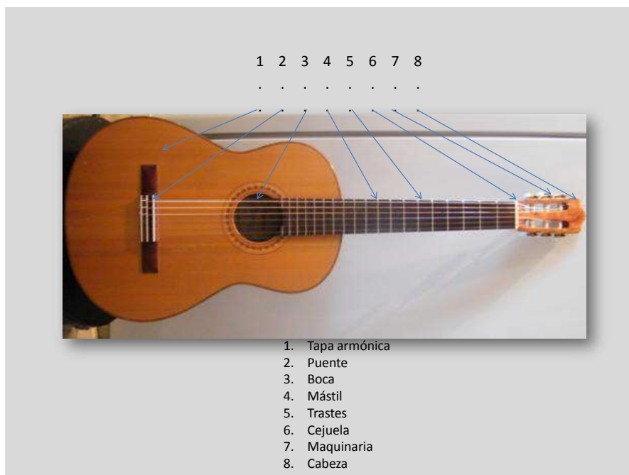
Ilustración 26. Esquema de la guitarra como instrumento de cuerda punteada
