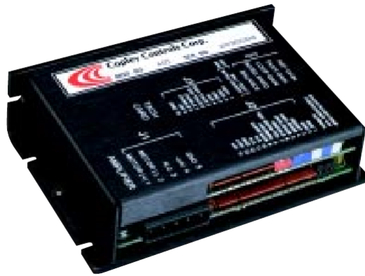
Figura 4.19: Servoamplificador utilizado para la potencia del motor del péndulo de Furuta.
