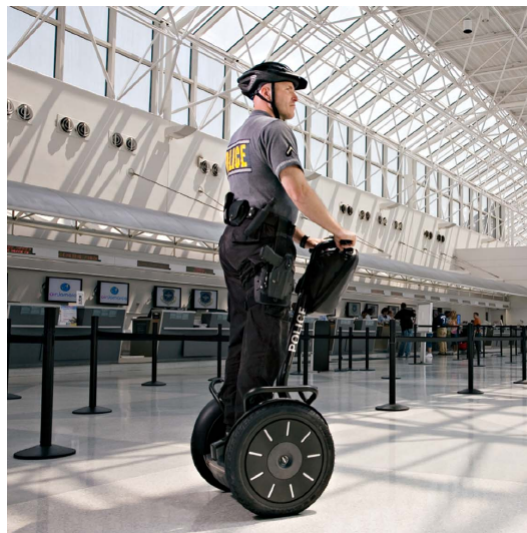
Figura 1.2: PPGar, vehículo basado en péndulo invertido.
