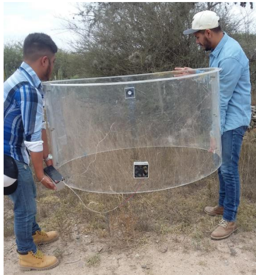
Fig. 3.8 Cámara siendo bajada sobre una especie a evaluar.
