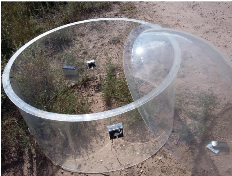
Fig. 3.1 Cámara portátil para la medición de la evapotranspiración.
