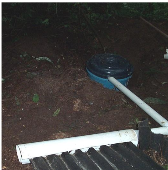
Figura 3.6 Extremo de la canaleta de lámina de cartón utilizada para la estimación de Precipitación Directa (troughfall o TF) que es la que alcanza el suelo de la comunidad e incluye goteo de las copas de los arboles (crowndrip).
