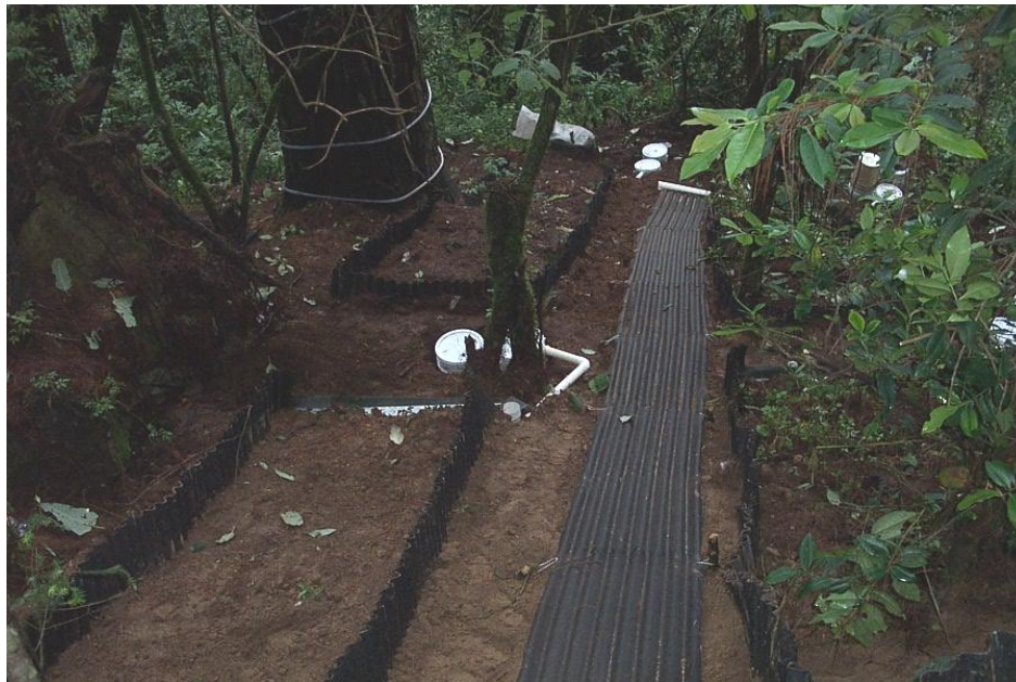
Figura 3.8. Disposición de final de 4 de las 7 parcelas experimentales para medición de escurrimiento y 1 de 5 canaletas para estimación de precipitación directa en el interior de la asociación con desarrollo de estrato arbóreo.
