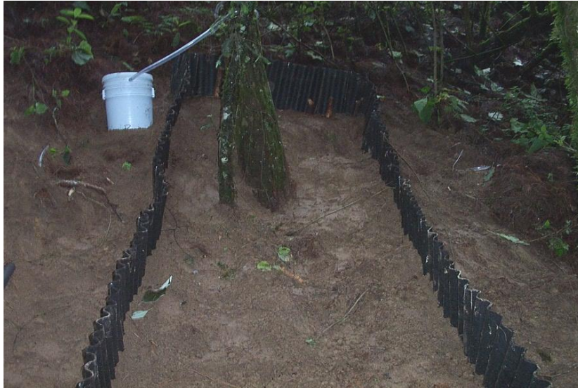
Figura 3.7. Collares o serpentines para estimación de escurrimiento fustal (SF) en el lote 1 (estrato arbóreo -suelo desnudo).
