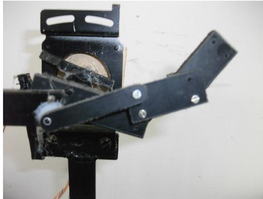
Figura 4.6: Ensamble del mecanismo para el dedo índice.
