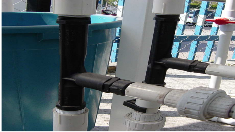
Figura 32. Sistema de inyección adaptado en el Campus UAQ Amazcala
