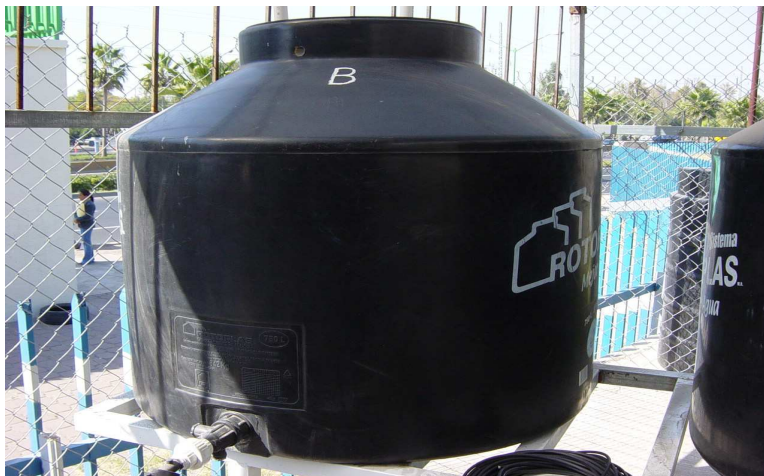
Figura 31. Tanques para fertilizantes instalados en el Campus UAQ- Amazcala
