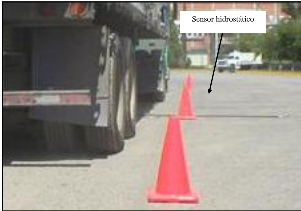
Figura 2-9: Sensor hidrostático ensayado en México (Romero y Lozano, 2008).
