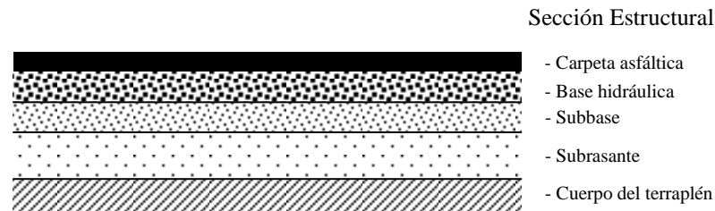
Figura 1-3: Estructura típica de un pavimento flexible (Arriaga y Garnica, 1998).
