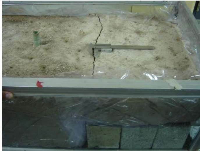
Figura 5.18. Fractura ocurrida en el modelo a escala; justo por encima del escalón.
