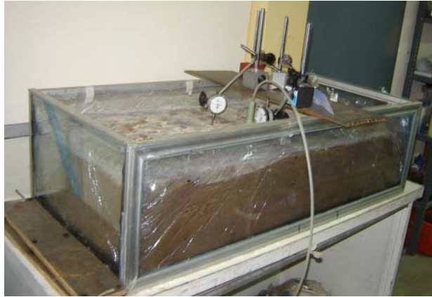
Figura 4.6. Modelo 1; instrumentado con 4 micrómetros, se observa el trabajo del modelo 1 por extracción de agua en la zona central.
