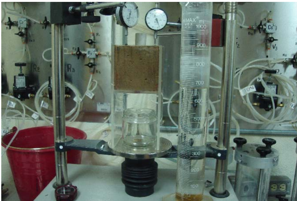
Figura 4.4. Modelo 1, instrumentado en la parte superior con micrómetros de deformación.
