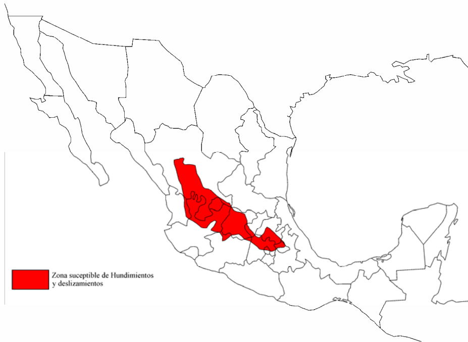
Figura 6.7 Mapa de la república mexicana donde se muestra en rojo las zonas susceptibles de que se generen hundimientos y fallamientos por extracción del agua subterránea. Adaptado de CENAPRED (2001)
