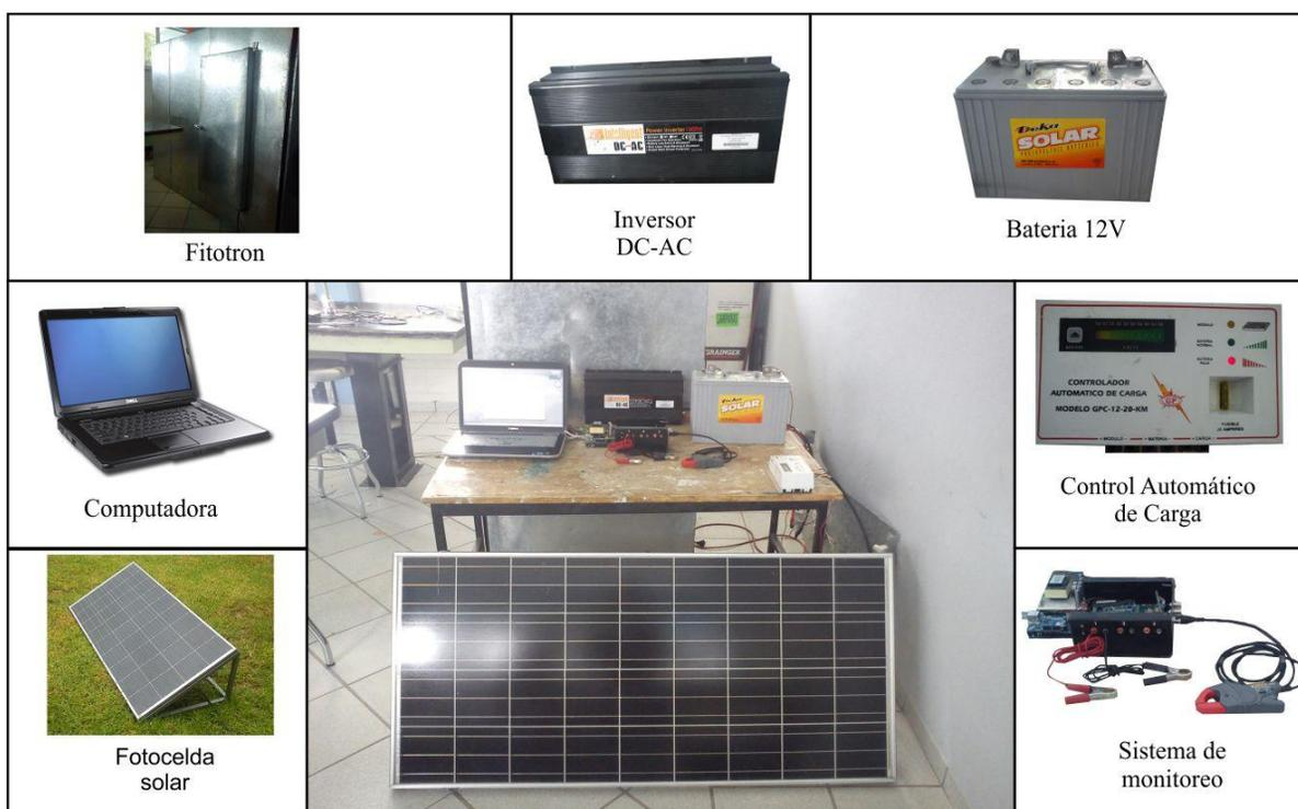
Figura 4.9. Componentes utilizados para monitoreo en Fitotrón.
