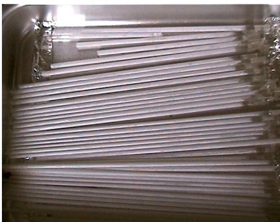
**Figura 4.1.** Varillas fijadas con dióxido de titanio inmovilizado.
