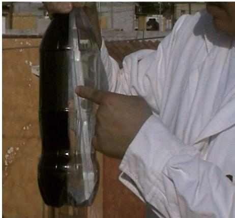
**Figura 4.3.** Reactor batch con varillas de vidrio fijadas con  $TiO_2$
