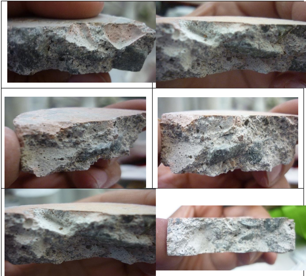
Ilustración 23. . Fotografías de corte de las muestras para mostrar el total de absorción.
