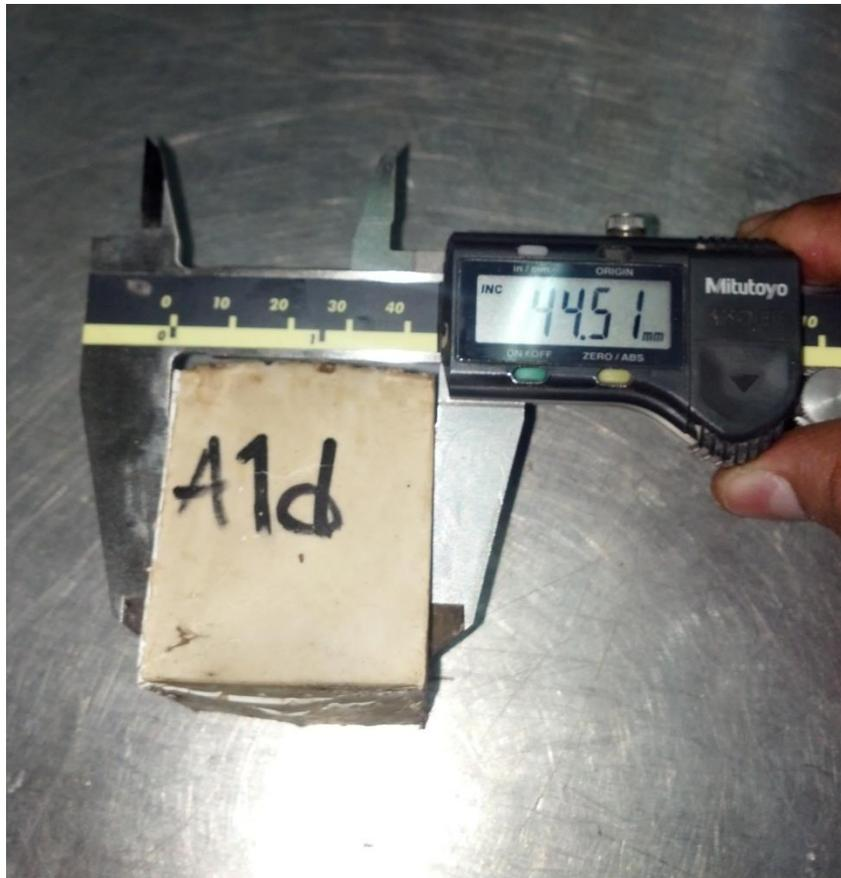
**FIGURA 16** Deformación de 6 mm la probeta después de ser ensayada a compresión, esta originalmente tenía 50.00 mm
