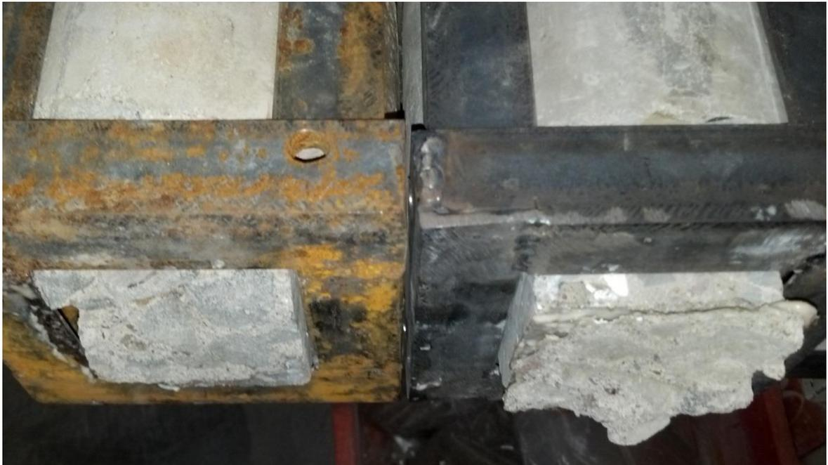
**FIGURA 19** Espécimen fallado en la prueba de Adherencia.
