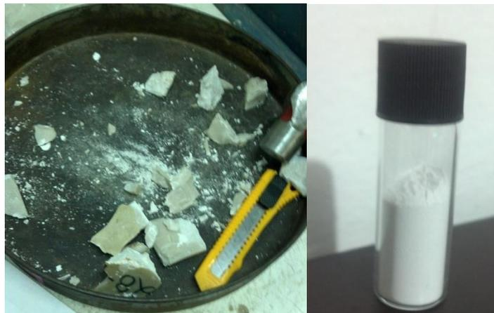
**FIGURA 13** Muestra disgregada para prueba de Difracción de Rayos X
