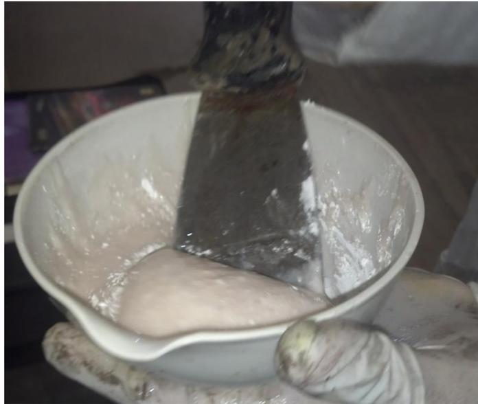
**FIGURA 5** Mortero Realizado con Resina y Cal
