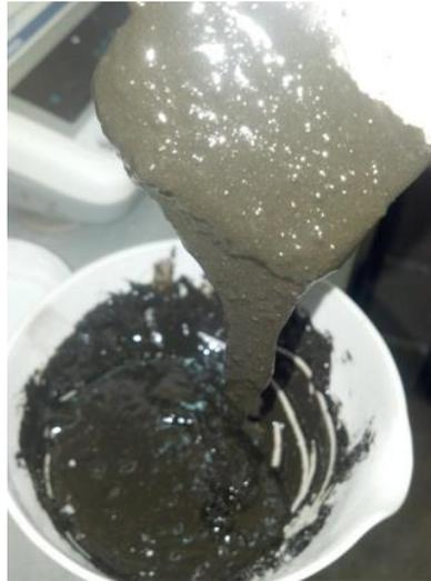
**FIGURA 9** Mortero Realizado con Resina y Arcilla Húmeda
