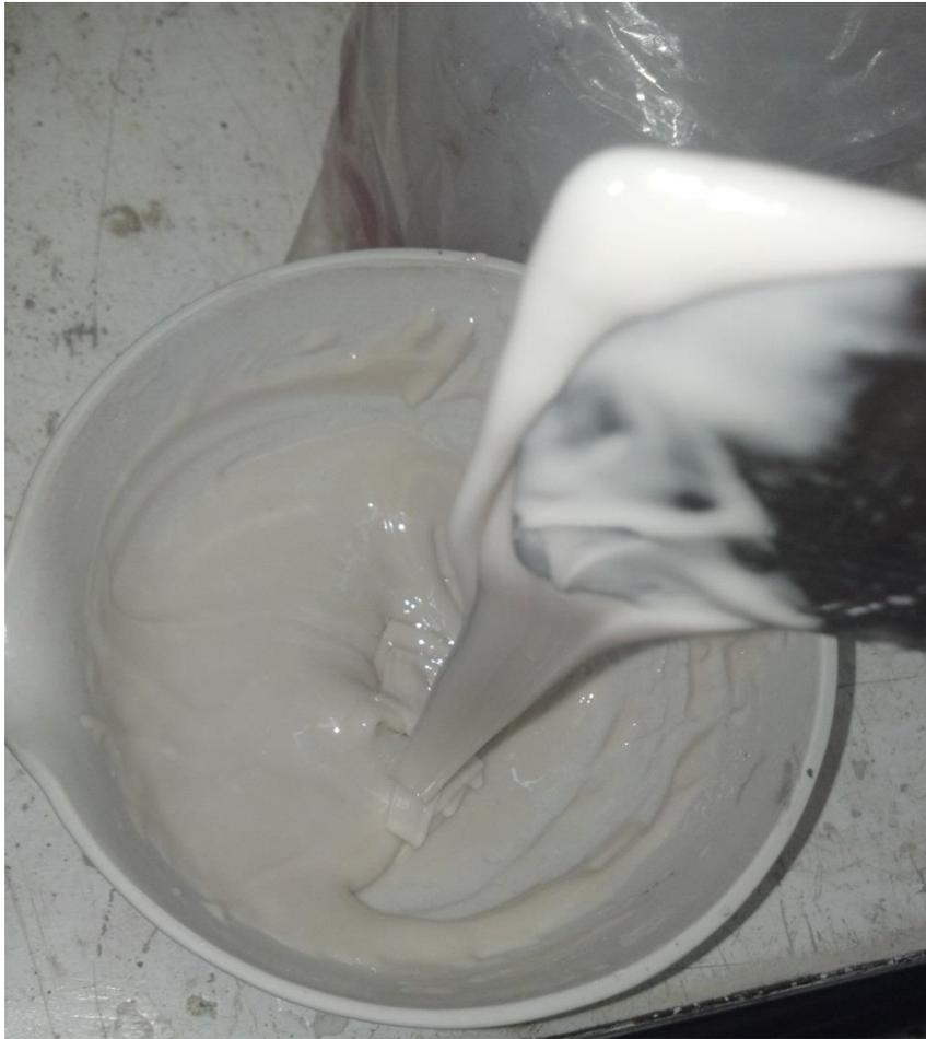
**FIGURA 6** Mortero Realizado con Resina y Calcita
