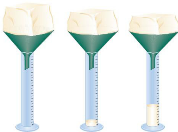
Figura 3.7 Prueba de goteo de crema batida después de 2 horas a 18-20°C. Fuente: Bylund (1995)
