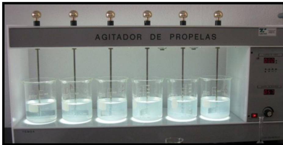
Figura. 20. Tercer ensayo con sulfato de aluminio para el agua de mar.
