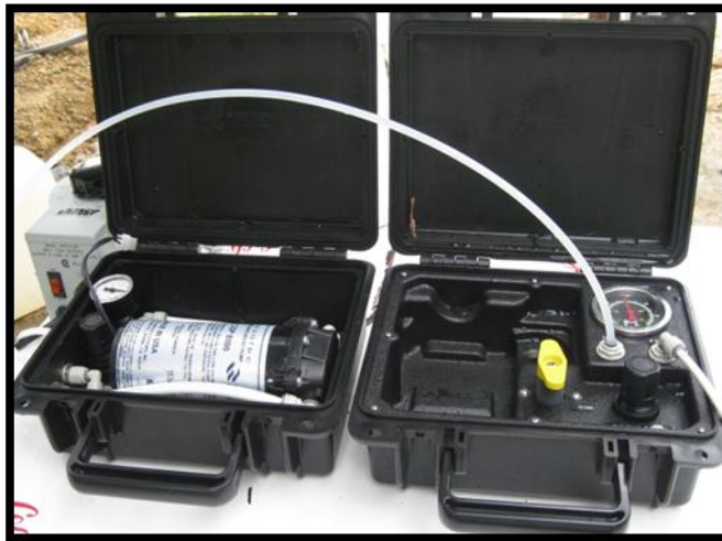
Figura 8. Equipo para determinación SDI
