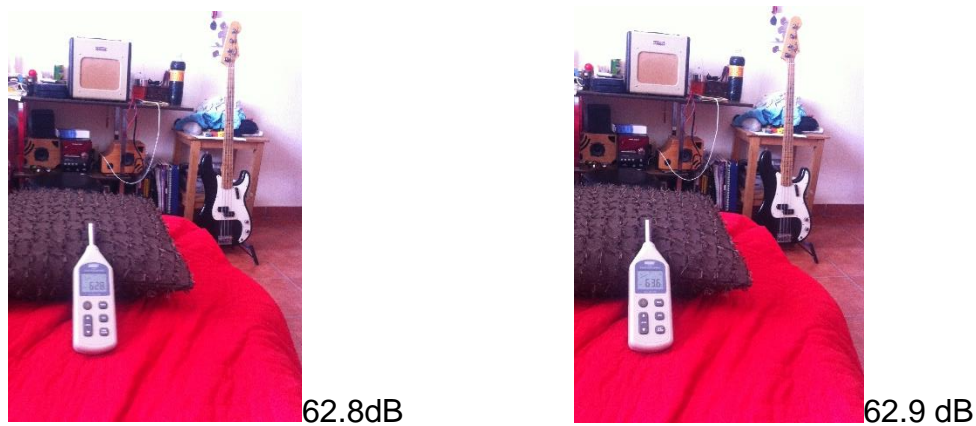
Figura 32. Pruebas de viabilidad de concepto (mediciones sin caja con fuente en cara posterior)
