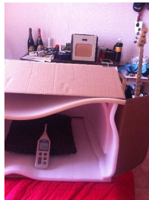
Figura 33. Pruebas de viabilidad de concepto (mediciones con caja con fuente en cara posterior)
