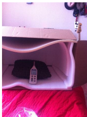
Figura 33. Pruebas de viabilidad de concepto (mediciones con caja con fuente en cara posterior)
