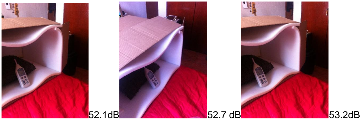
Figura 35. Pruebas de viabilidad de concepto (mediciones con caja con fuente en cara lateral)
