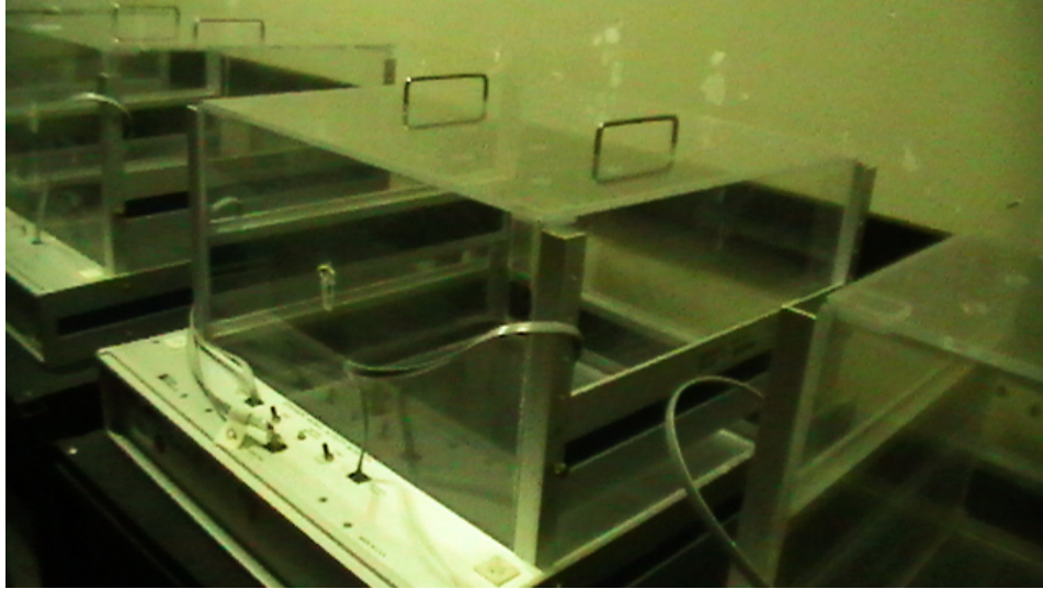
Fotografía de las cajas de actividad locomotora (AGMS)
