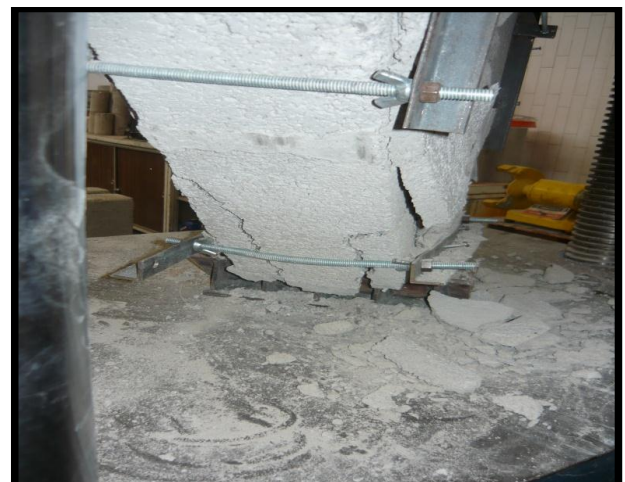
Figura 38 . Falla por aplastamiento.
