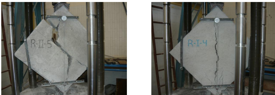
Figura 43. Tipos de falla presentados en muretes no reforzados pero recubiertos.
