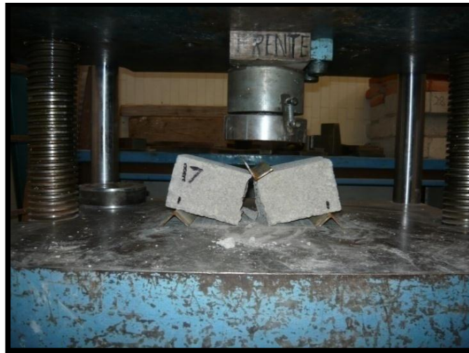
Figura 22. Prueba para determinar el módulo de ruptura.
