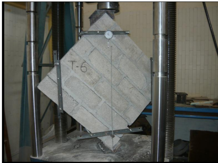
Figura 29. Forma de ensaye de muretes.
