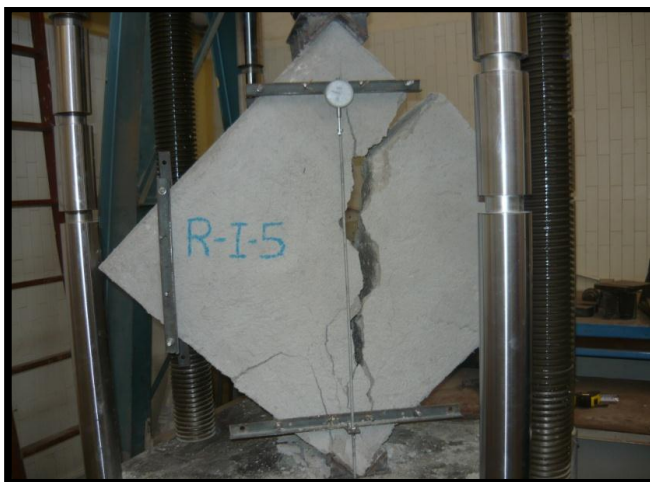
Figura 37. Falla por tensión diagonal.
