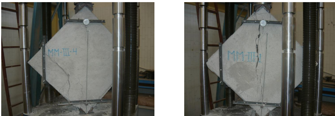
Figura 45. Tipos de falla presentados en muretes Reforzados con Multimalla.
