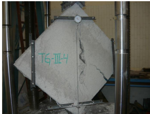
Figura 46. Tipos de falla presentados en Muretes Reforzados con Tela de Gallinero.
