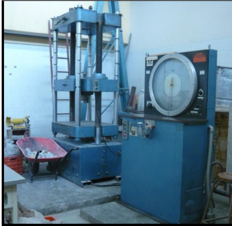
Figura 26. Máquina de prueba usada para el ensaye de pilas.
