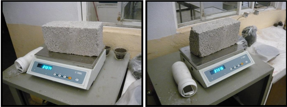
Figura 23. Proceso de pesado para el cálculo del peso volumétrico.
