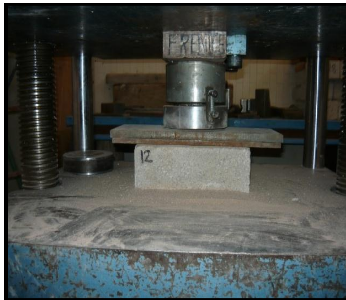
Figura 18. Ensayo a compresión de tabicones.
