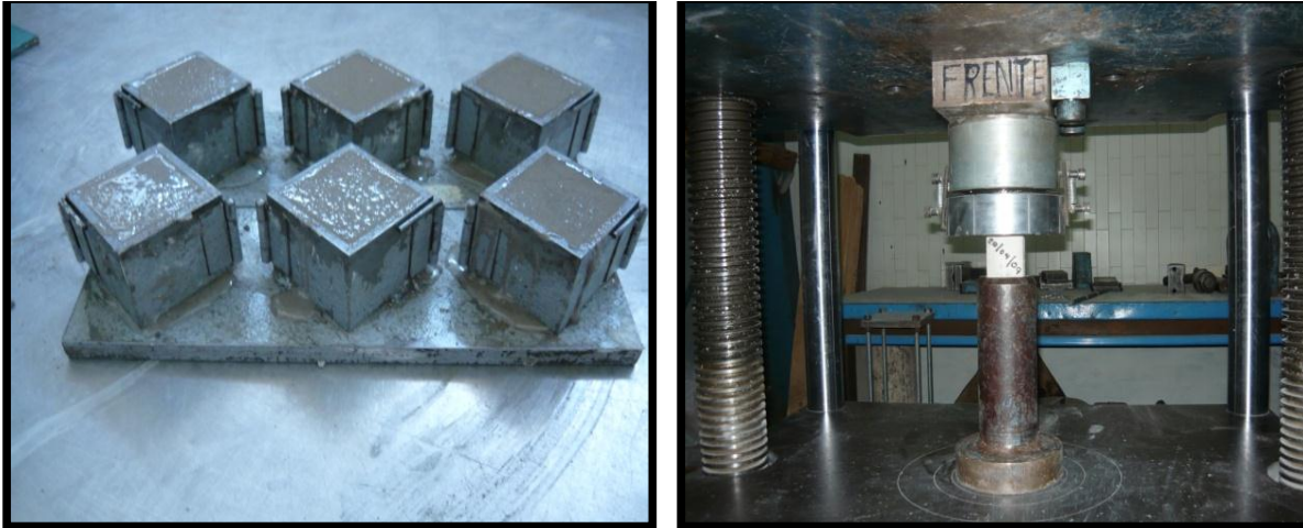
Figura 24. Cubos de muestras de mortero, y su ensaye correspondiente
