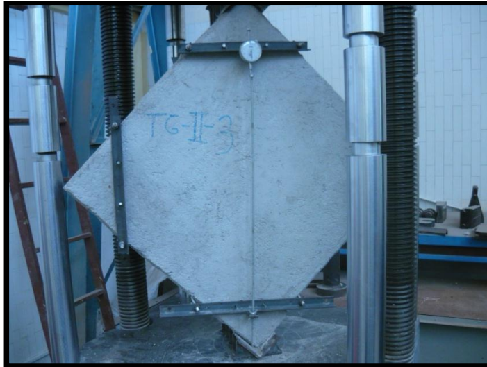
Figura 27. Dispositivo para medir el acortamiento y el alargamiento de las diagonales.
