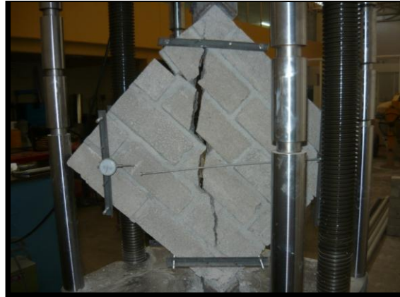
Figura 32. Falla producida por tensión diagonal
