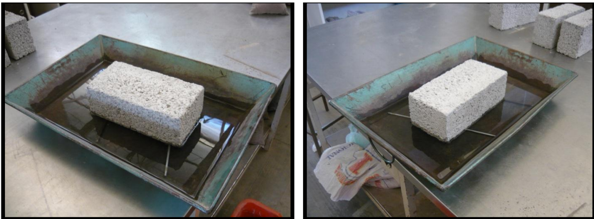
Figura 19. Prueba de Absorción inicial.
