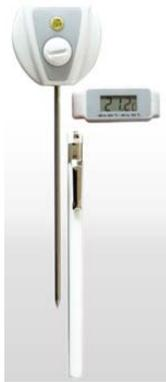
Figura 28. Termómetro digital para suelo
