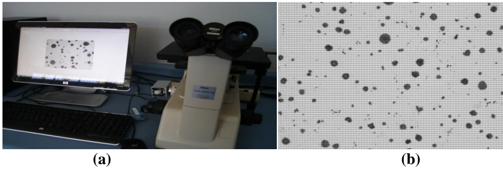
Figura 15 a) Microscopio empleado en la captura de las imágenes b) Imagen de la microestructura de una muestra.
