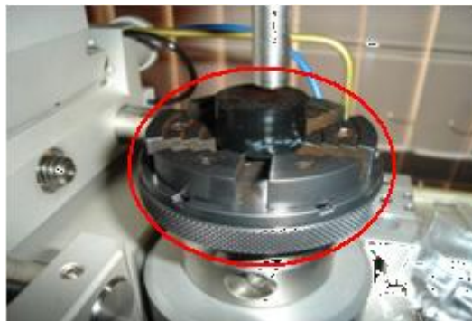
Figura 20 Sujeción de la muestra en chuck del tribómetro
