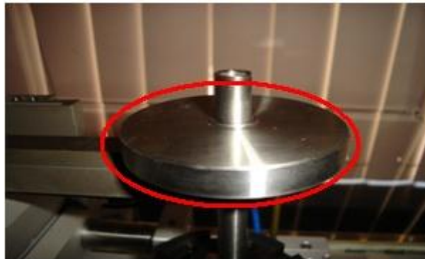
Figura 22 Aplicación de la carga de 2 Newton.
