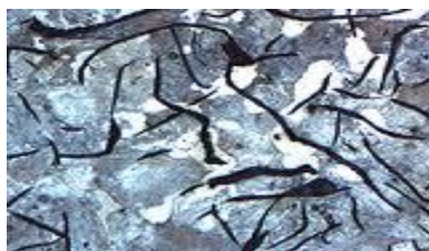
Figura 1 Hojuelas de grafito en hierro fundido gris (x100).
