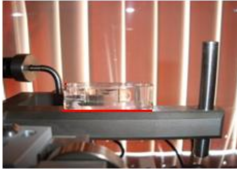
Figura 18 Nivelación del brazo porta perno.
