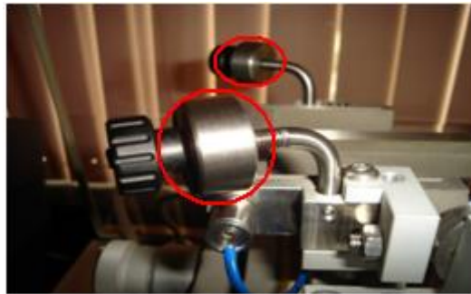
Figura 19 Ajuste de las tuercas de balanceo del brazo porta perno
