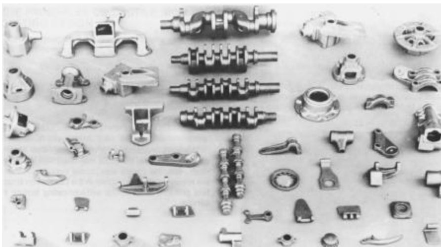
Figura 9 Partes automotrices, fabricadas con hierro nodular. (Acosta, 2000)
