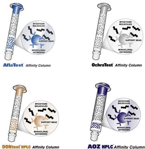
Figura 6. Columnas de inmunoafinidad de VICAM: Aflatest™ (aflatoxinas totales: AFB 1 , AFB 2 , AFG 1 , AFG 2 y AFM 1 ), FumoniTest™ (fumonisina total: B 1 , B 2 y B 3 ), OchraTest™ (ocratoxina A) y ZearalaTest™ (zearalelona).
