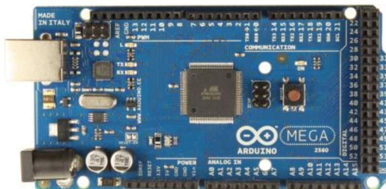
Figura 2.11. Placa electrónica Arduino Mega2560.
