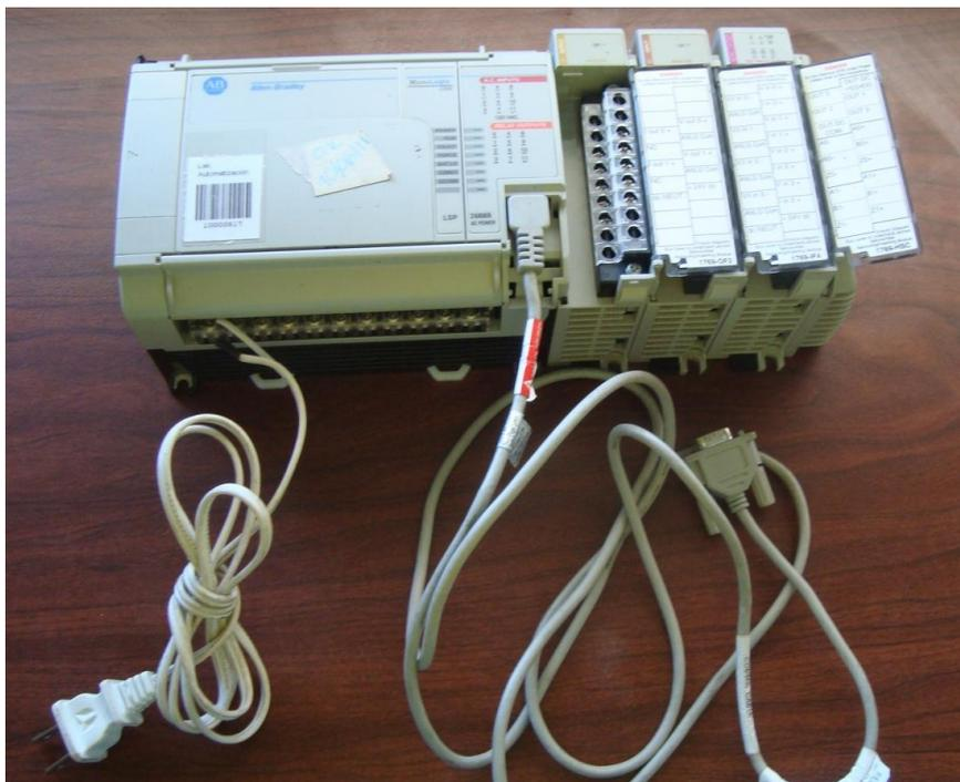
Figura 3.4 Controlador MicroLogix 1500, conectado a una fuente dual.
