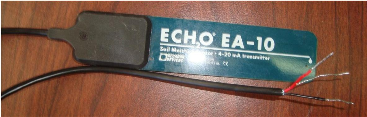
Figura 3.12. Sensor de humedad del suelo EA-10, 4-20 mA.
