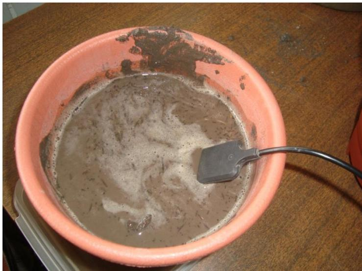
Fig. 4.2. Caracterización de la Humedad máxima para el sensor de humedad.
