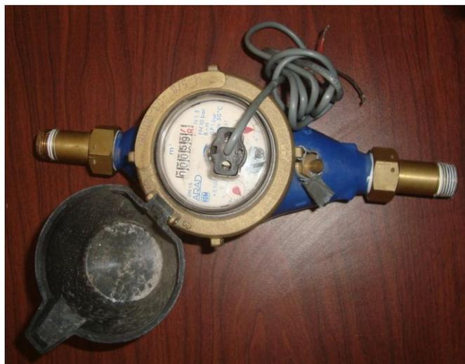
Figura 3.1 Medidor de flujo de agua marca Arad, modelo M.
