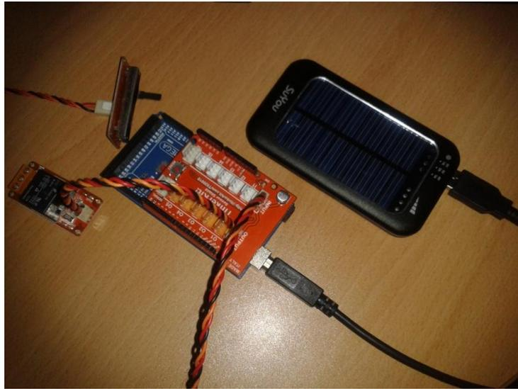
Fig. 4.5. Tarjeta Arduino con celda solar como alimentación sustentable.
