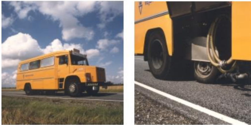
Figura 2.- Stradograf, funcionando. Fuente: Agencia Sueca de Transporte
