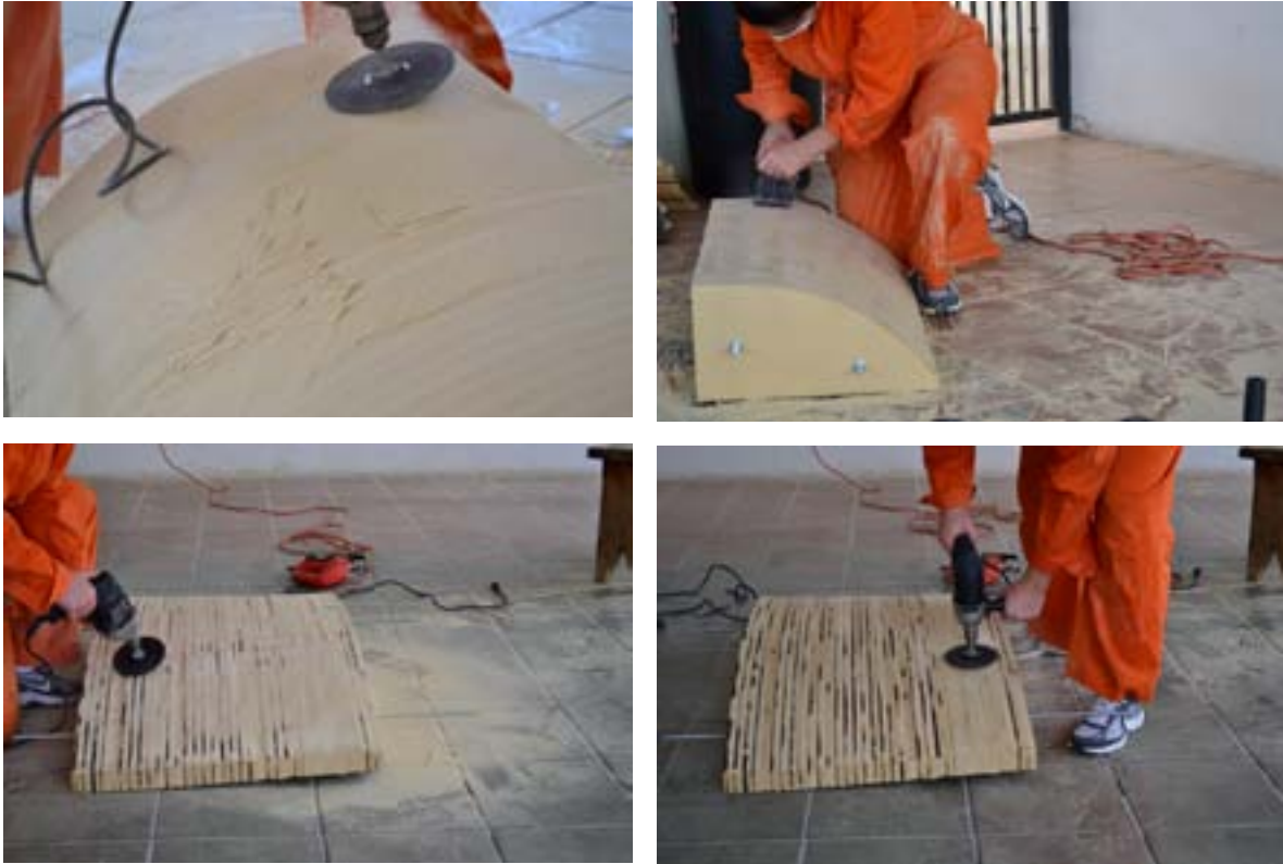
Fig. 38. Lijado y acabado de planos seriados para remover bordes.
