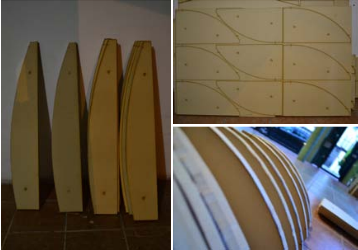
Fig. 36. Corte de planos seriados en MDF de 18mm para armado de molde.
