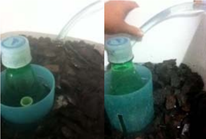
Fig. 32. Comparación de niveles de agua. Donde existe un aumento anormal de nivel de agua en biofiltro (imagen izquierda).
