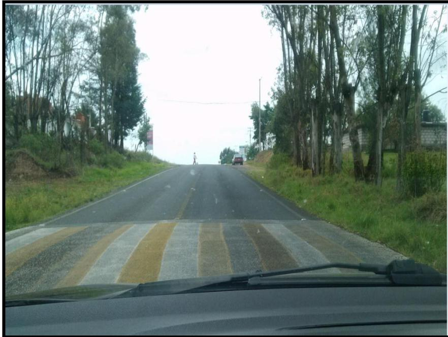
**Figura 4.4** Se muestra otra secuencia de dos topes a aproximadamente a 5 min de Amealco de Bonfil.
