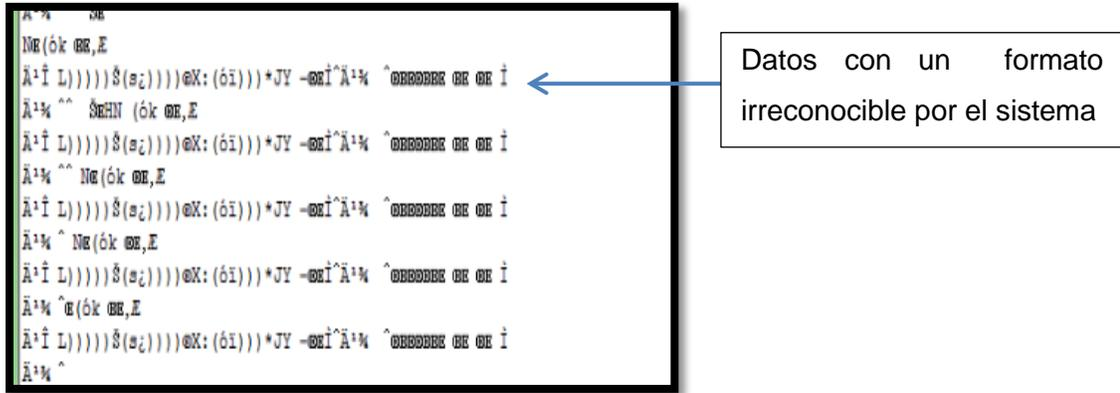
**Figura 3.6** Se muestra la cadena de caracteres obtenida del módulo GPS cuando éste no ha tenido una correcta inicialización.
