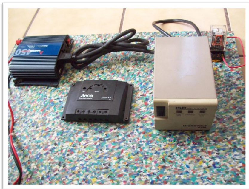
Figura 3.11 Regulador, Controlador de carga para las Baterías de Ciclo Profundo e Inversor de CD-CA.
