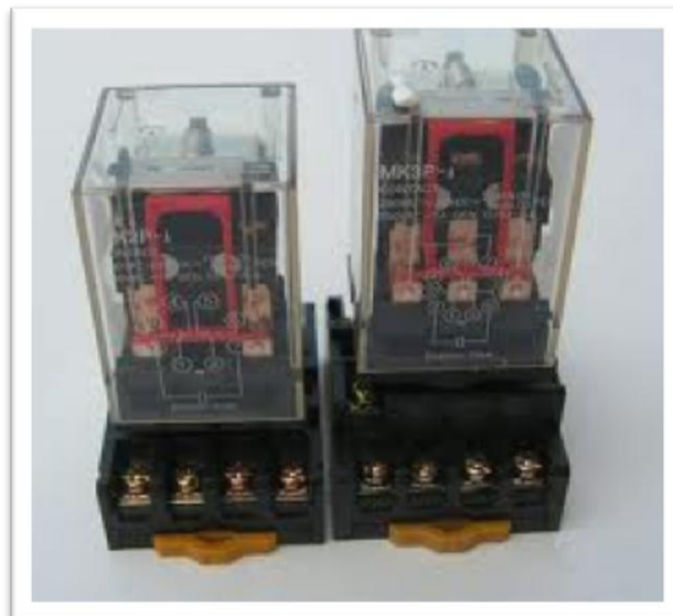
Figura 3.14 El relevador encapsulado se encargara de vincular la Energía Renovable y convencional CFE, en caso de falla en el equipo.
