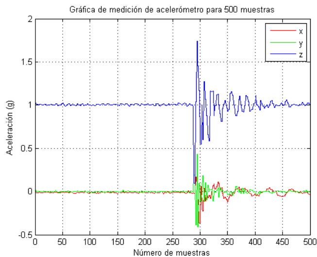
Figura 4.7.- Mediciones de acelerómetro obtenidas mediante comunicación inalámbrica.
