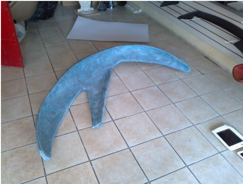
Figura 42. Matriz de molde inicial, en espuma de poliuretano y pasta automotriz, recubierta con fibra de vidrio.
