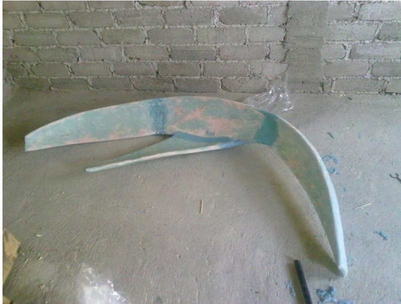
Figura 41. Matriz de molde inicial, en espuma de poliuretano y pasta automotriz.
