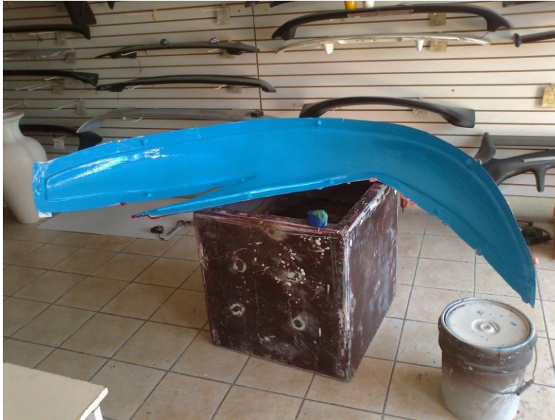
Figura 47. Parte superior del molde de la pala terminado.
