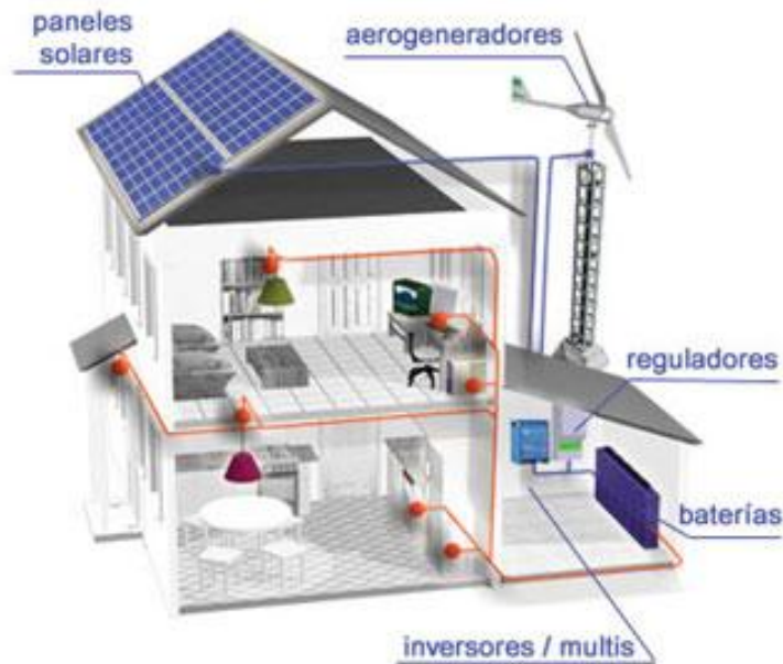
Figura 14. Principales componentes en una instalación de producción independiente de energía a escala doméstica.
