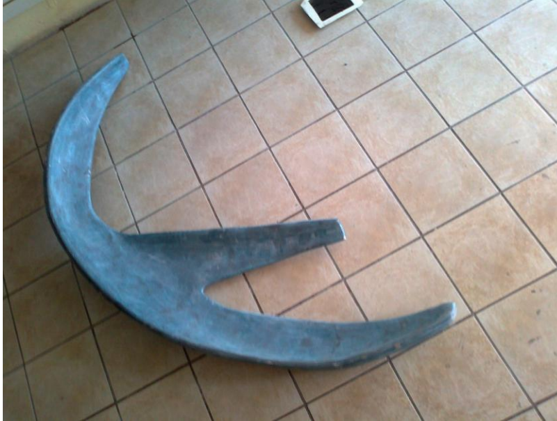
Figura 43. Matriz de molde inicial, recubierta con talco industrial.
