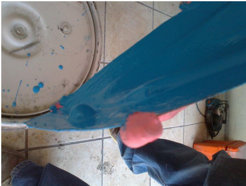
Figura 46. Primera capa de molde, con puntos de desmoldeo vista 2.
