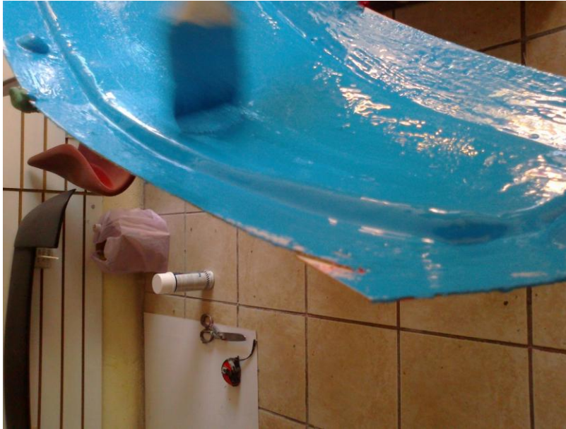
Figura 44. Primera capa de molde, con borde reforzado y aplicación de poliéster isoftálico.
