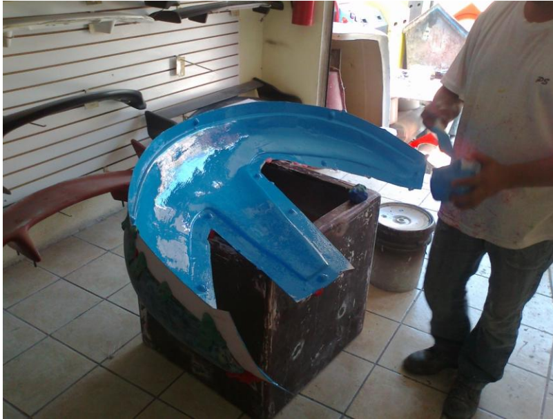
Figura 45. Primera capa de molde con recubrimiento vista 1.
