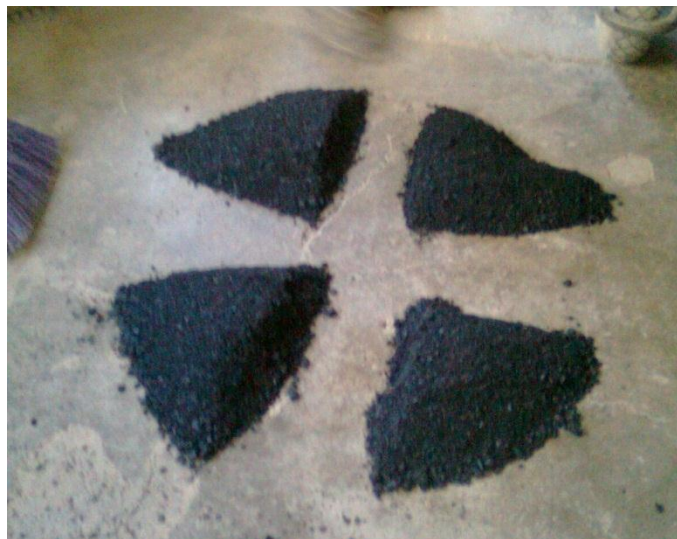
Figura 3. 4 Cuarteo de la muestra de mezcla asfáltica.
