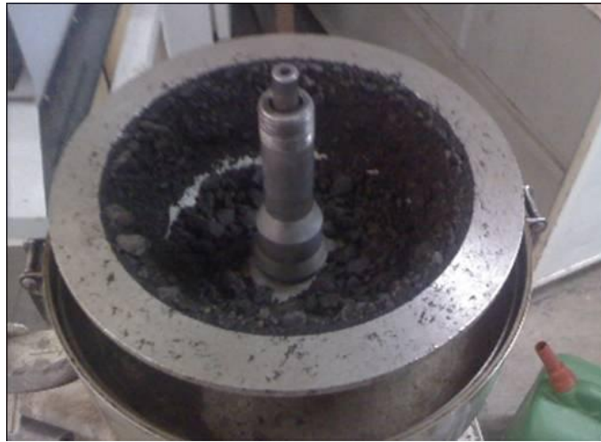
Figura 3. 5 Colocación de material en equipo Rotarex
