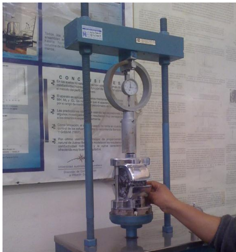
Figura 3. 10 Ensaye de los especímenes de mezcla asfáltica en la prensa de Marshall, para la determinación de estabilidad y flujo.
