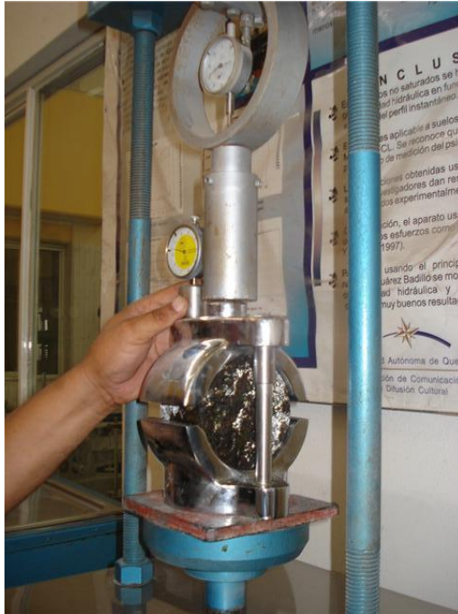
Figura 2. 8 Espécimen colocado entre las dos secciones de la cabeza de prueba Marshall.
