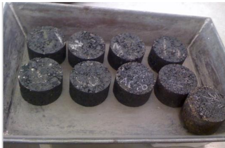
Figura 3. 8 Especímenes de concreto asfáltico, elaborados mediante el método de Marshall
