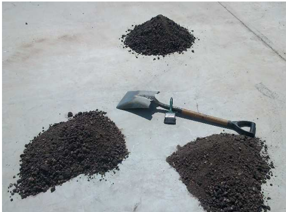
Figura 4-5 Cuarteo de los materiales
