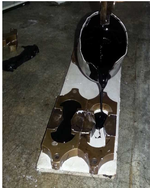
Figura 3-5 Elaboración de briquetas para la prueba de ductilidad
