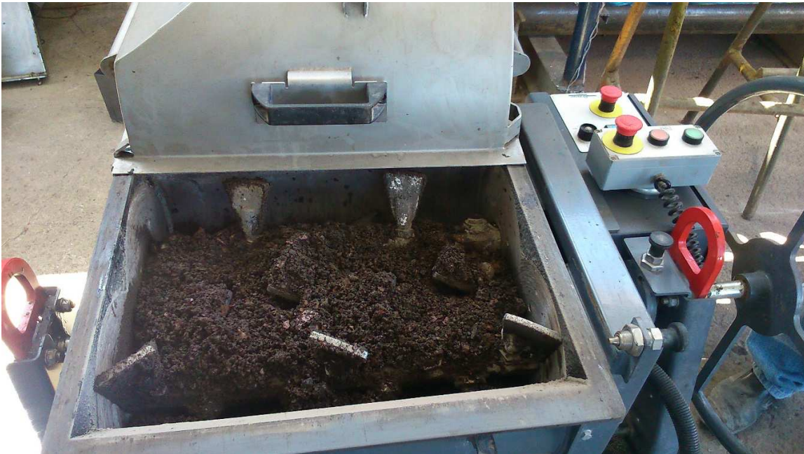
Figura 3-15 Mezcla terminada de RAP, Filler industrial y asfalto espumado con 75% de la humedad óptima.
