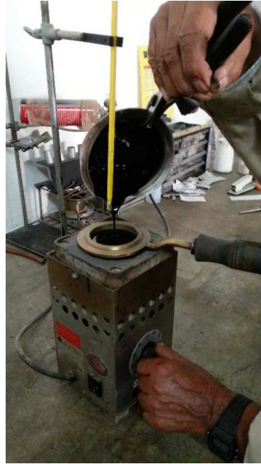
Figura 3-3 Preparación de la muestra para Punto de inflamación Cleveland
