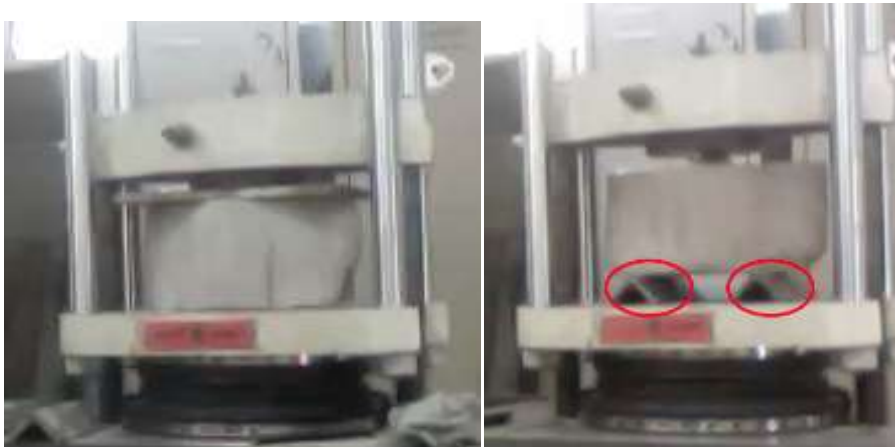
Figura 3.4.2.2. Determinación de resistencia a esfuerzos de compresión y flexión simple en bloques
