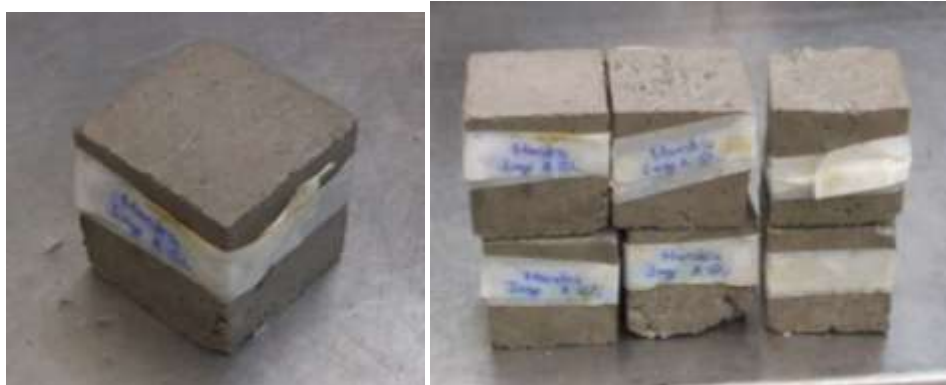
Figura 3.6.1.2. Cubos de mortero a los 28 días de curado
