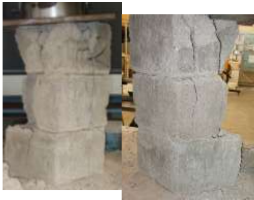
Figura 4.3.3. Patrón de colapso en pilas con juntas de mortero
