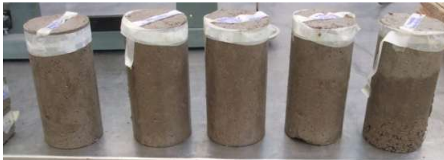
Figura 3.2.1.4. Probetas cilíndricas a los 28 días de curado
