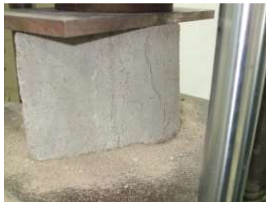
Figura 4.2.2. Aparición de grieta apreciable en un bloque
