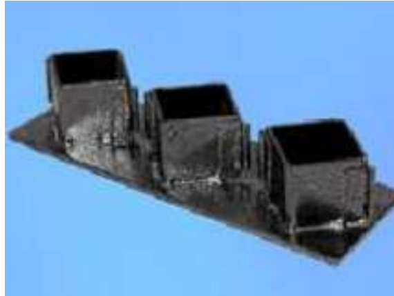
Figura 3.6.1.1. Molde para la fabricación de cubos de mortero
