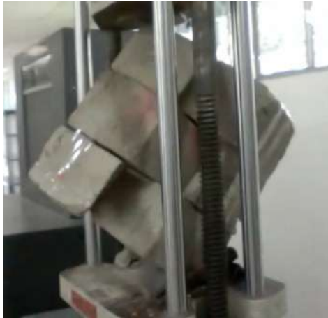
Figura 4.4.2. Patrón de colapso en muretes sin juntas de mortero sujetos a esfuerzos de tensión diagonal
