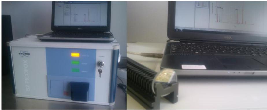
**Figura 4.4.1** Equipo de Fluorescencia de Rayos X.
