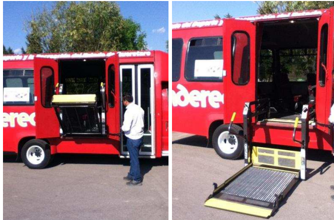
1.32 Salida de rampa para acceso a personas con discapacidad al camión.
