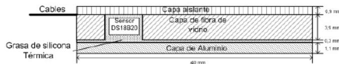
**Figura. 3.7 Sección transversal del sensor diseñado para su utilización en el exterior [imagen tomada de [12]].**
