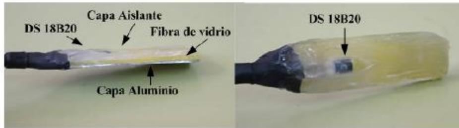
**Figura. 3.8 Sensor encapsulado para aplicaciones en exteriores** [imagen tomada de [12]]
