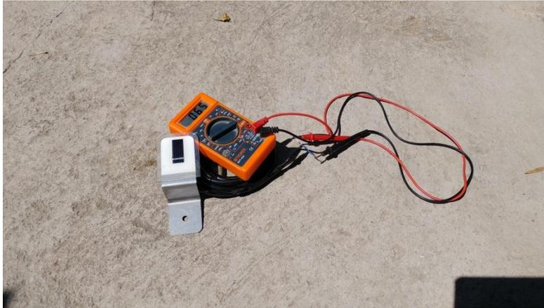
**Figura. 4.37 Medición de mV de Sensor de irradiación a diferentes horas de día cuando el sol es más intenso [creación propia].**
