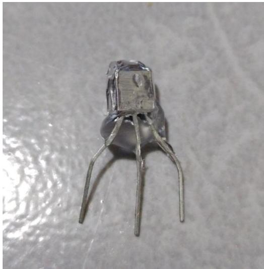
**Figura. 4.52 Sensor de Temperatura DS1820 con recubrimiento de aluminio y silicón [creación propia].**
