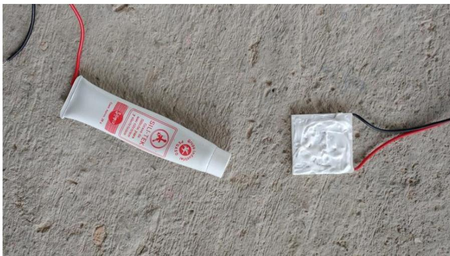
**Figura. 4.48 Celda Peltier con grasa silica [creación propia].**
