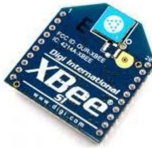
**Figura. 3.11 Modulo XBee S1 de Digi [imagen tomada de [11]].**
