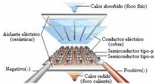
**Figura. 2.4. Estructura de una celda Peltier** [imagen tomada de [7] ].
