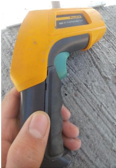
**Figura. 4.32** Termómetro IR modelo 568 marca Fluke [creación propia].
