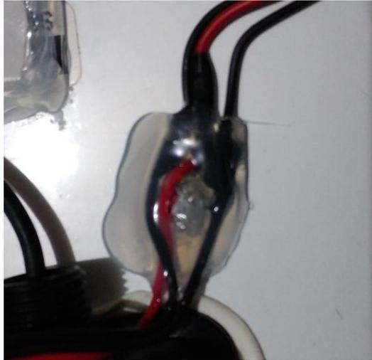
**Figura. 4.53 Sensor de Temperatura DS1820 fijado con silicón Caliente [creación propia].**
