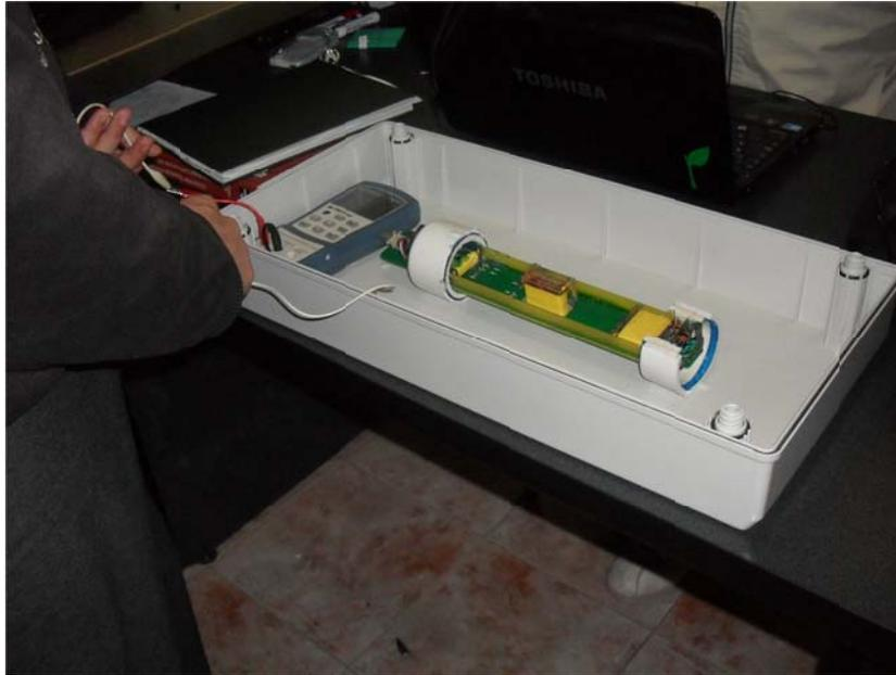
Figura 60. Magnetómetro tipo fluxgate. Se observan las tres componentes del campo medido.
