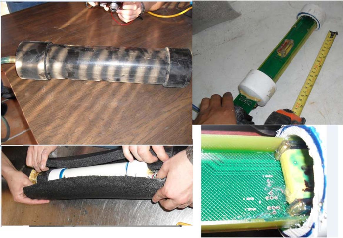
Figura 62. Se muestran los siguientes elementos de arriba abajo y de izquierda a derecha: Tubo de PVC, dentro del mismo se encuentra otro tubo de PVC color blanco, forrado con hule espuma color negro, dentro del segundo tubo se encuentran tres bobinas tipo toroide con transformadores elevadores (*drive* y *sense*), las bobinas están recubiertas de aceite que se supone controla la temperatura del equipo.
