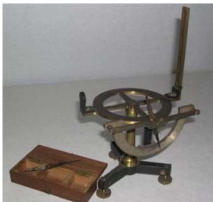
Figura 58 Imagen de una súper brújula de Hotchkiss construida a finales del siglo XIX y que comercializó la marca francesa Ducretet.
