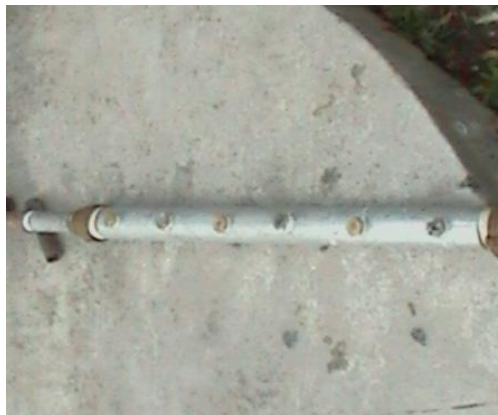
Figura 2.14. Banco de prueba de boquillas.
