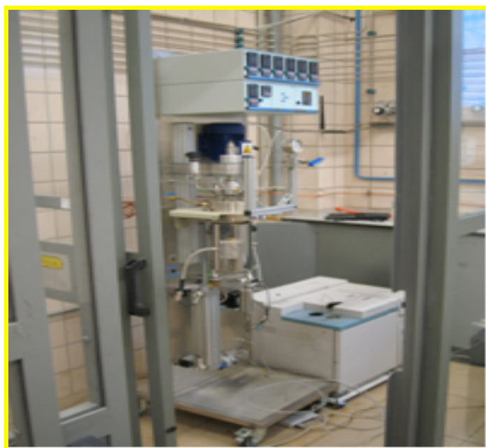
Fotografía del equipo utilizado (Sistema de reacción integrado por un Controlador de flujo de gases, Reactor tubular de cuarzo de lecho fijo y un cromatógrafo de gases).
