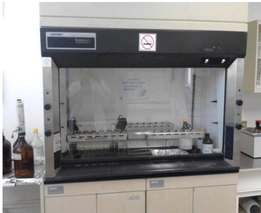
Figura 9. Campana de extracción
