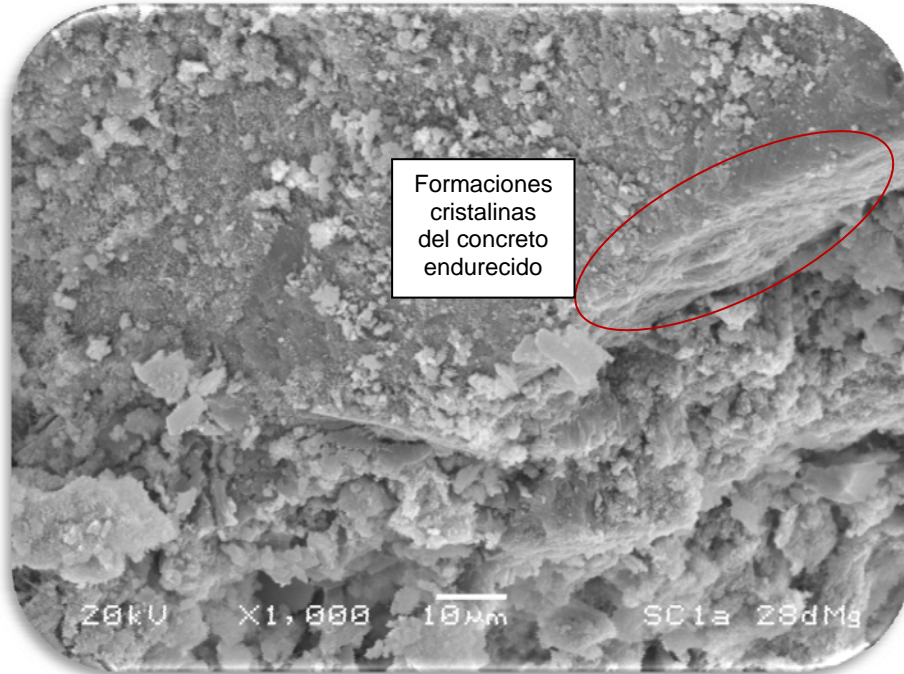
Figura 4.7. Micrografía de la mezcla sikacrete 950-DP a 28 días, atacada con MgSO_4
