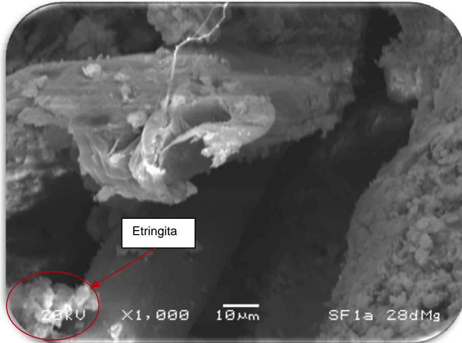
Figura 4.9. Micrografía de la mezcla sikafiber a 28 días, atacada con MgSO_4
