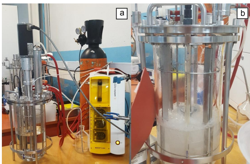
Figura 19. Reactor biostat a plus en el que se realizó la fermentación de D. hansenii con el medio definido 3. a) Tiempo de fermentación 2 h. b) Tiempo de fermentación 60 h.
