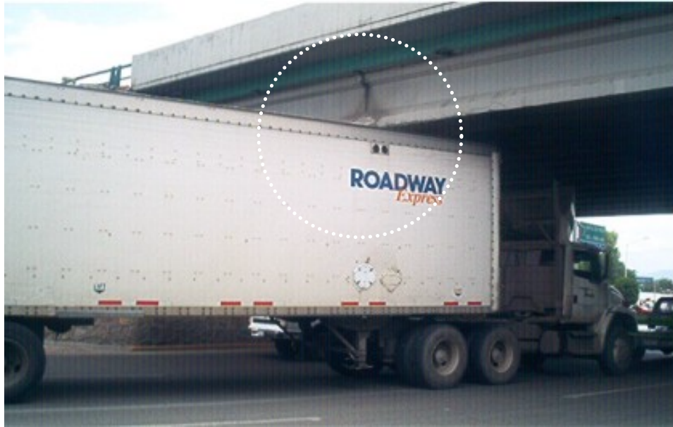
Figura 5.49. Camiones T3-S2 de carga con altura excesiva
