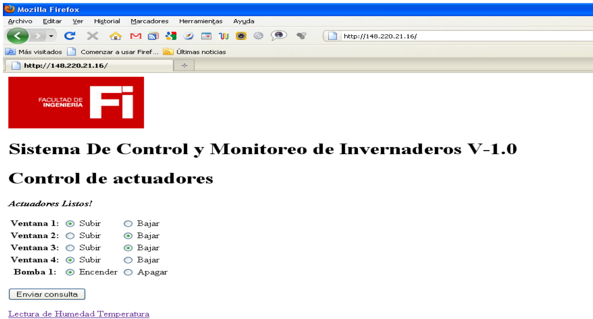
Figura 4.6 Diseño de la pagina web del sistema de control
