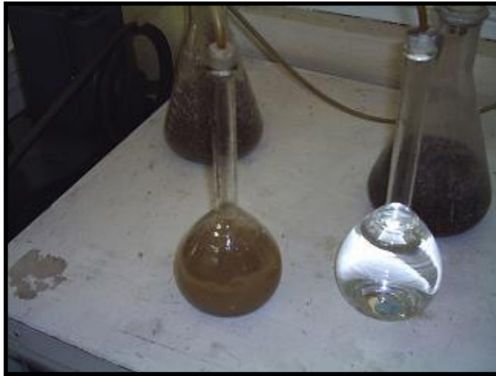
Figura 4.16. Extracción de aire mediante la bomba de vacío.
