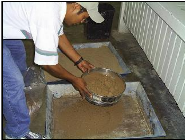
Figura 4.10. Cribado del tepetate por la malla No. 4.
