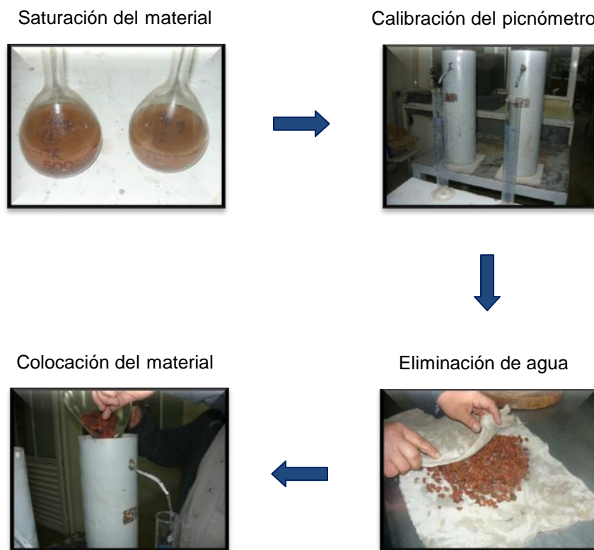
Figura 8. Procedimiento para conocer densidad real de tezontle.
