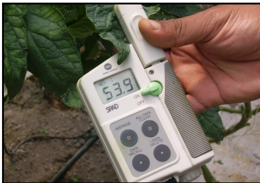
Figura 12. Medición de clorofila con el equipo Minolta SPAD 502 Chlorophyll meter.
