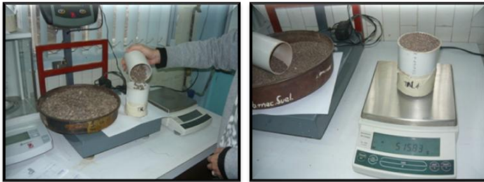
Figura 7. Llenado con muestra seca del cilindro y peso del cilindro con la muestra.
