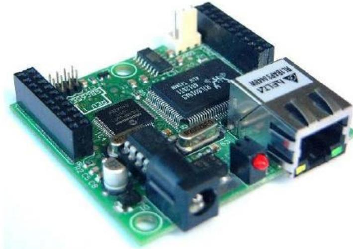
**Figura 3. Tarjeta modtronix modelo SBC65EC**
